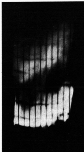
Abb. 4. Charakteristische Gefügekammeraufnahme des einkristallinen \beta -rhomboedrischen Bors.
